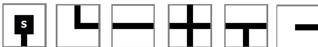
Рис. 3. Виды секций лабиринта и их количество для формирования произвольных лабиринтов. «Площадка» - 5 шт, «Поворот» -8шт, «Прямая» -4шт, «Перекресток - X» -3шт, «Перекресток - Т» - 6шт, «Тупик» - 2шт.
