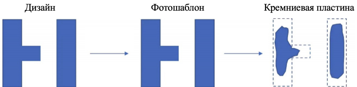
Рис. 4. Результат фотолитографии без коррекции оптической близости
