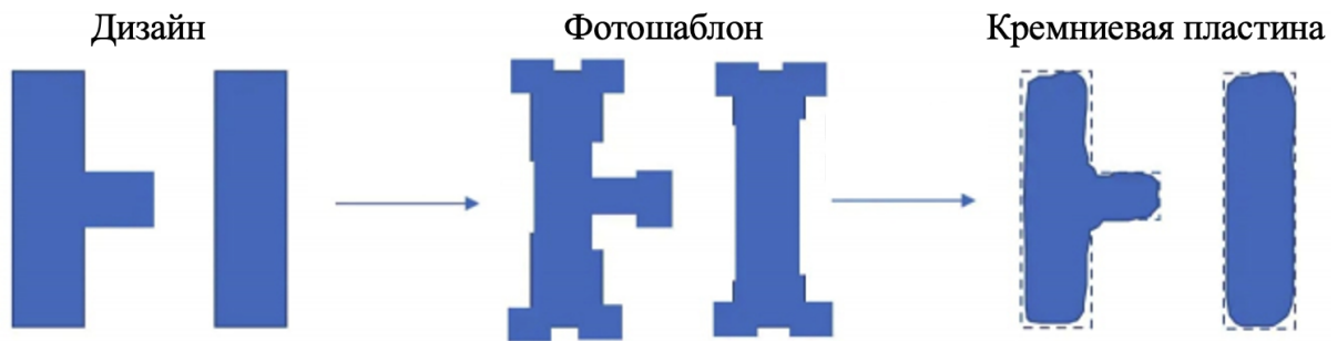
Рис. 3. Результат фотолитографии с коррекцией оптической близости
